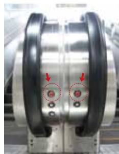
自动扶梯两端均安装电梯紧急停止装置，按压即停。
